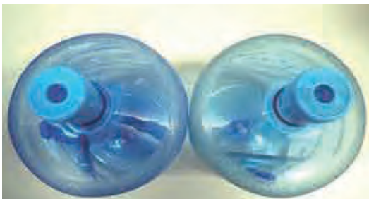
正常ボトル（青色） 屋外保管で生じた退色劣化
